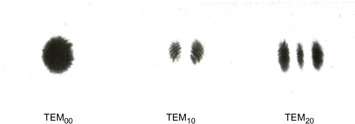
Bild 4.4: TEM-Modenformen für rechteckige Spiegel im Resonator [58]
