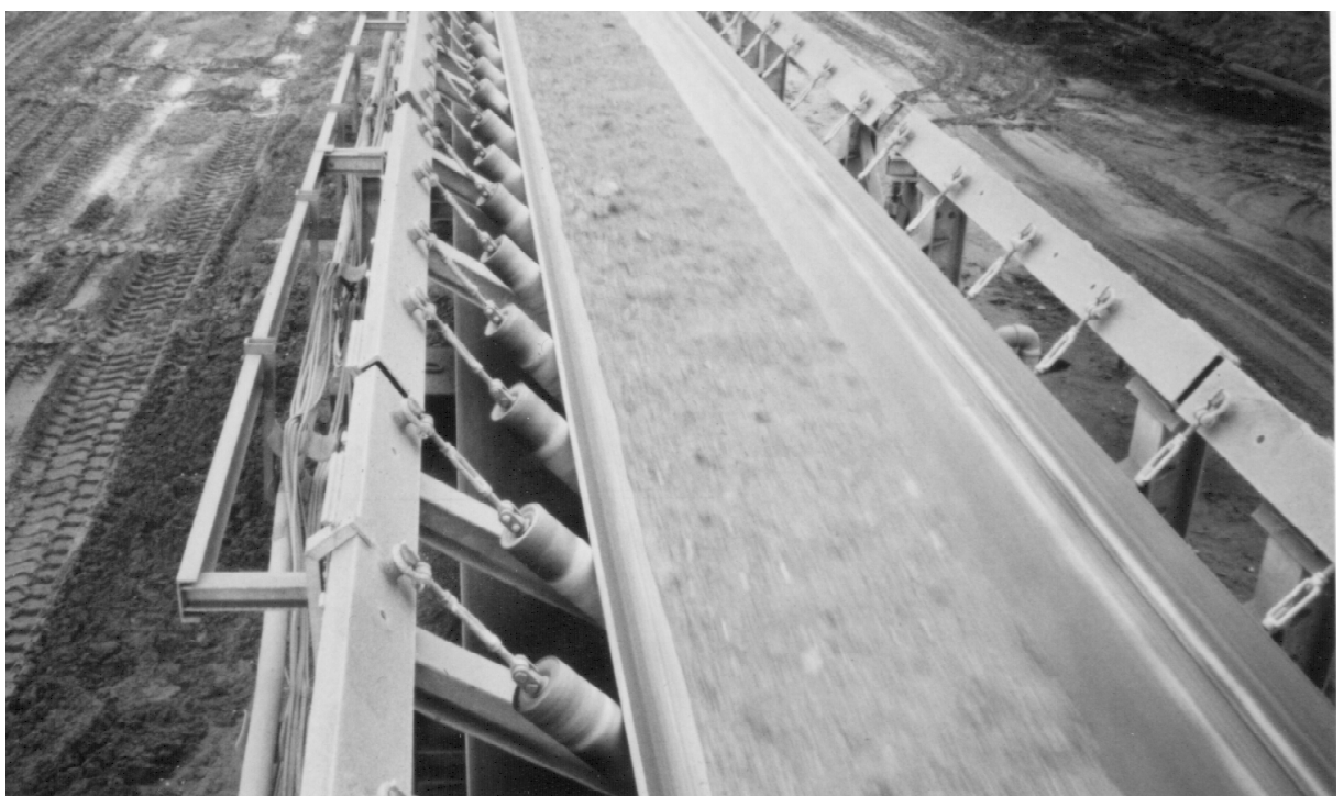
Bild 2.8: Asymmetrisch in den Tragrollengirlanden laufender Fördergurt
