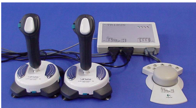
Abb. 42: Handbediengerät mit Joysticks und SpaceMouse
