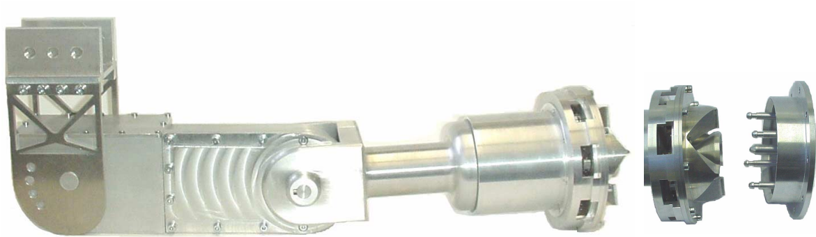
Abb. 24: Manipulator mit Arretierungseinheit (l.) und Arretierungseinheit mit Kupplung (r.)
