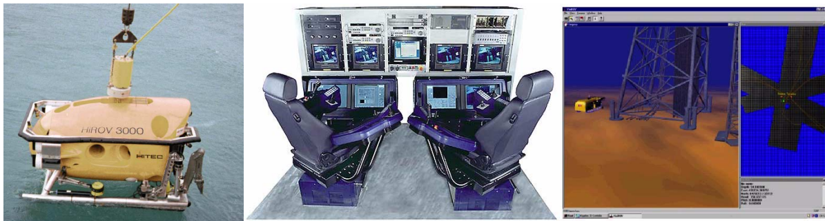
Abb. 1: ROV HiROV3000 (l.) mit Leitstand Cyberbase (m.) und 3D-Visualisierung VisiROV(r.)
