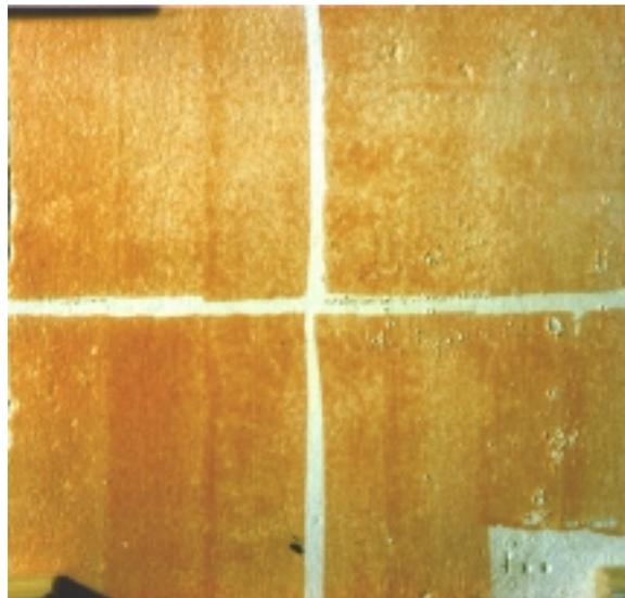
Abb. 17: Schadensbild durch Casein auf Probeplatte 100, Mennige, Kalkcasein nach Alterung (Foto T. Trapp)
