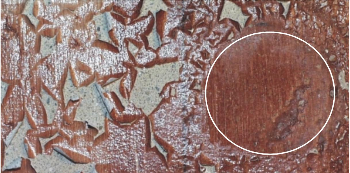
Abb. 52: Nahaufnahme Probplattenoberfläche (Probplatte 139, Eisenoxidrot (Wienhausen), Ammoniumcasein), 3 Monate Alterung nach Caseinabbau:
