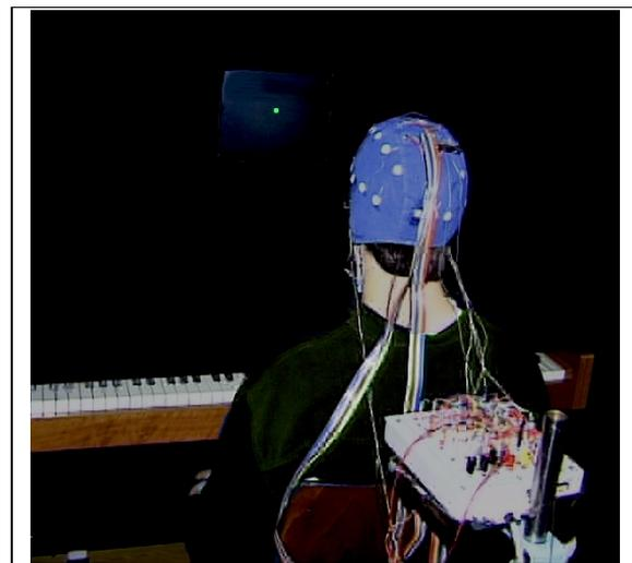
*Abb.2.3: Blick in die mattschwarze Versuchskammer über die Schulter eines Probanden. Man erkennt die blaue EEG-Haube, den EEG-Vorverstärker (**rechts unten**), die Klaviertastatur mit unmittelbar darüber befindlicher Sichtblende und den schwarzen Monitor mit angezeigtem grünen Fixationspunkt (**oben Mitte**). Der visuell reizarme „Schwarzeindruck“ der Fotografie in Blickrichtung der Versuchsperson entspricht den tatsächlichen Verhältnissen.*
