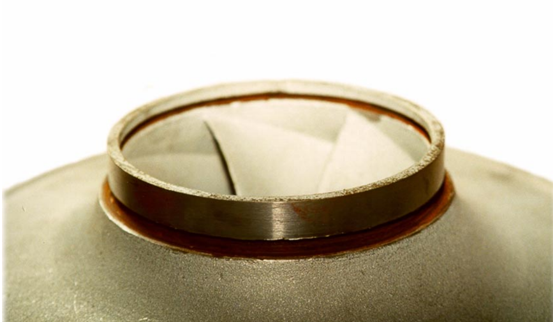
Bild 39: Eisenring zur Verbesserung der magnetischen Leitfähigkeit im Saughals
