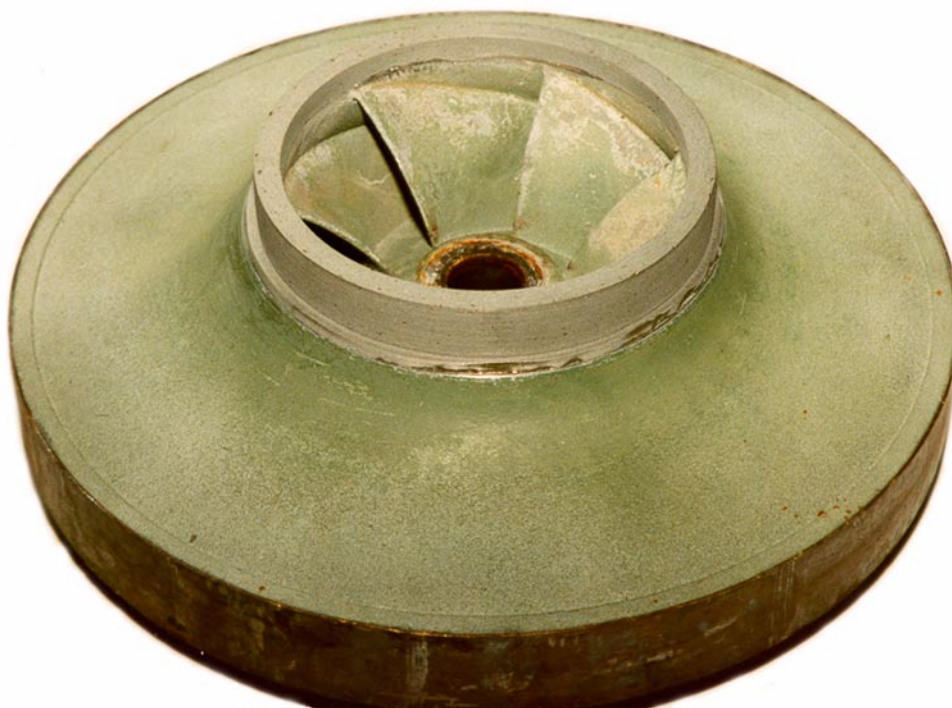
Bild 40: Versuchslaufrad mit beschichtetem Saughals und abgedecktem Austritt
