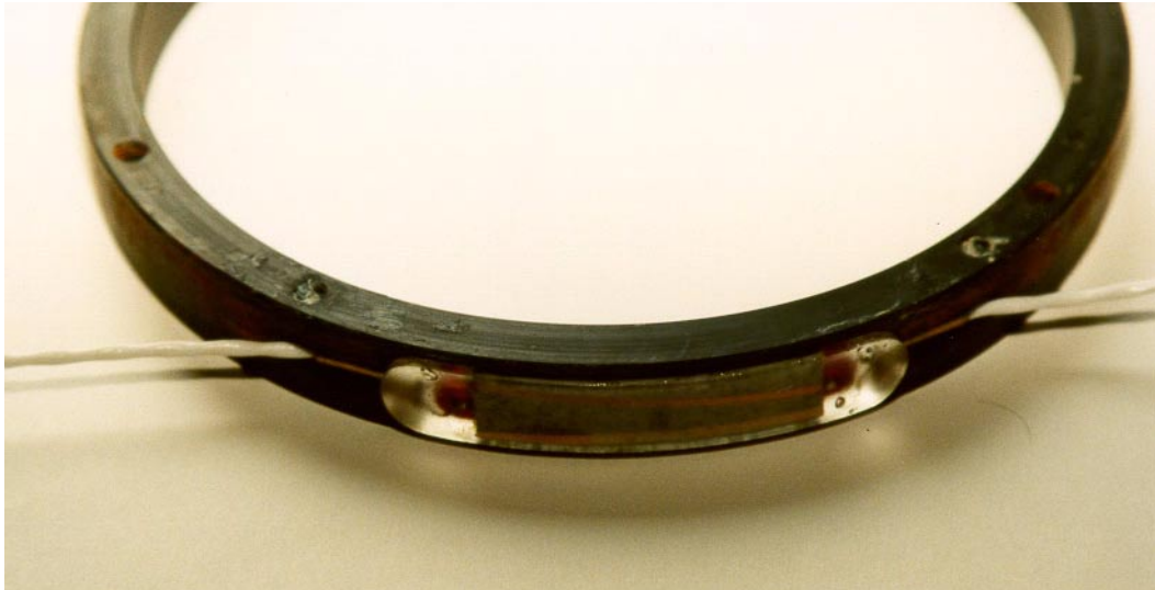
Bild 37: Meßring mit eingebautem Meßaufnehmer
