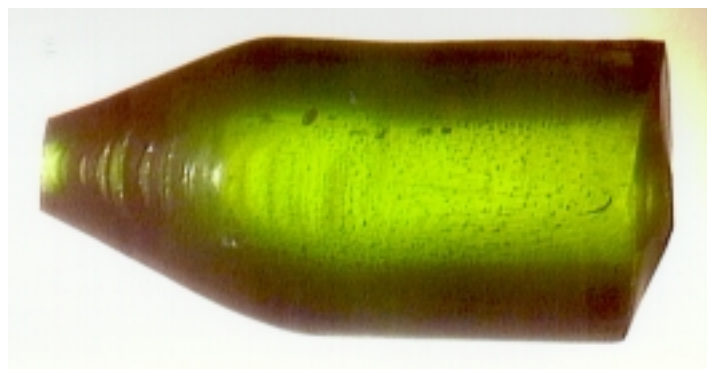
Abbildung 44: SPG-Einkristall 6, L = 35 mm, D = 18 mm (Grünfärbung des Kristalls durch Temperung in reduzierender Atmosphäre, s. F.3.2.)
