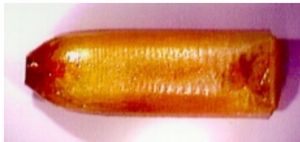
Abbildung 27: Züchtungsprodukt aus der Schmelze Nr. 8 (L = 45 mm, D = 18 mm)
