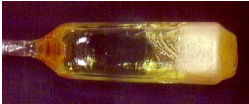
Abbildung 28: Kristall aus Schmelze 12 (L = 50 mm, D = 18 mm)
