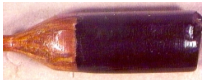
Abbildung 45: SPG 9, Kristallanfang undurchsichtig, mehrphasig anschließend klarer Kristall, L = 50 mm, D = 18 mm
