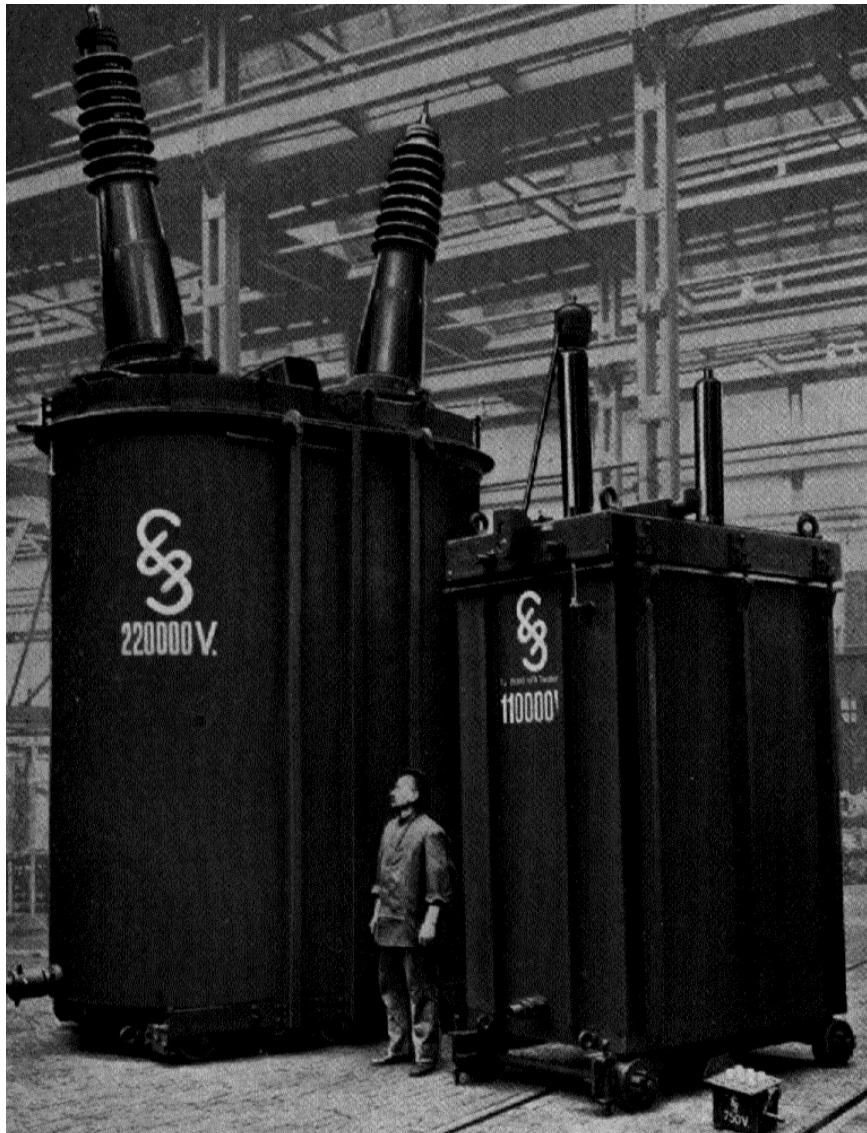
Bild 1.10: Größenvergleich von 750 V, 110 kV und 220 kV-Innenraum-Schalter, 1926
