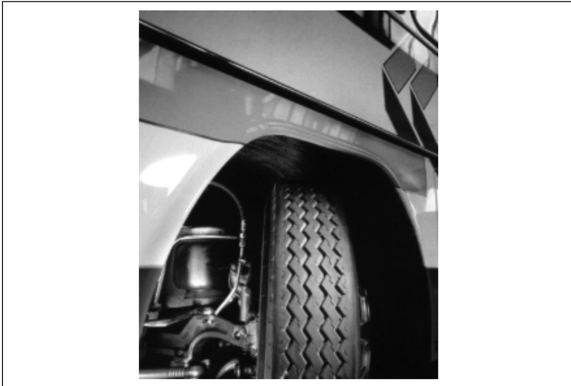
Abbildung 2: Luftfeder im Fahrwerk eines Busses
