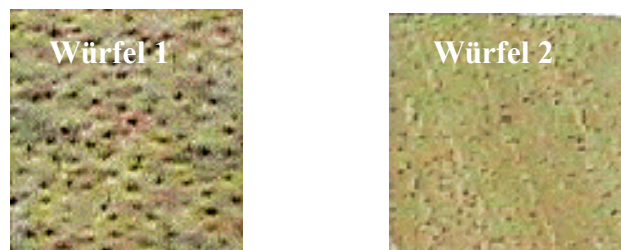
Abb. 23 Schnittfläche zweier Holzwürfel mit unterschiedlicher Porösität (Kantenlänge: 10 mm, gleiche Vergrößerung)
