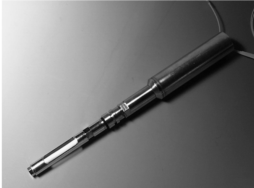
Abb. 11: Kombination aus ESIP Probenahmemodul und dem modifizierten FIA-System zum Einbau in einen Braun Biostat M Bioreaktor; Gesamtlänge ca. 40 cm
