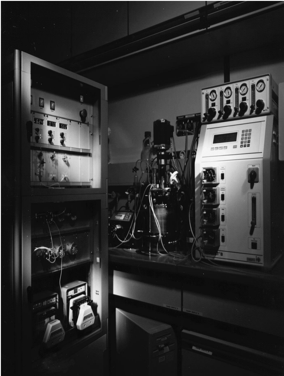
Prozeßanalysator im Einsatz an einer Tierzellkultivierung
