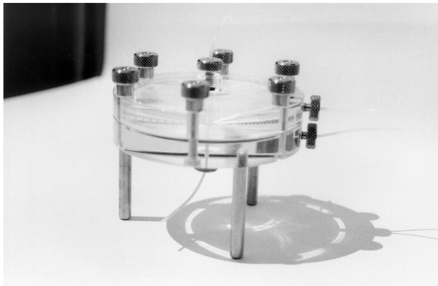
Entgasungszelle zur Ammoniakentfernung
