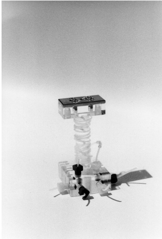
Multifunktionsmodul mit Dispersionstrecke und Luftblasenfalle (Anasyscon)
