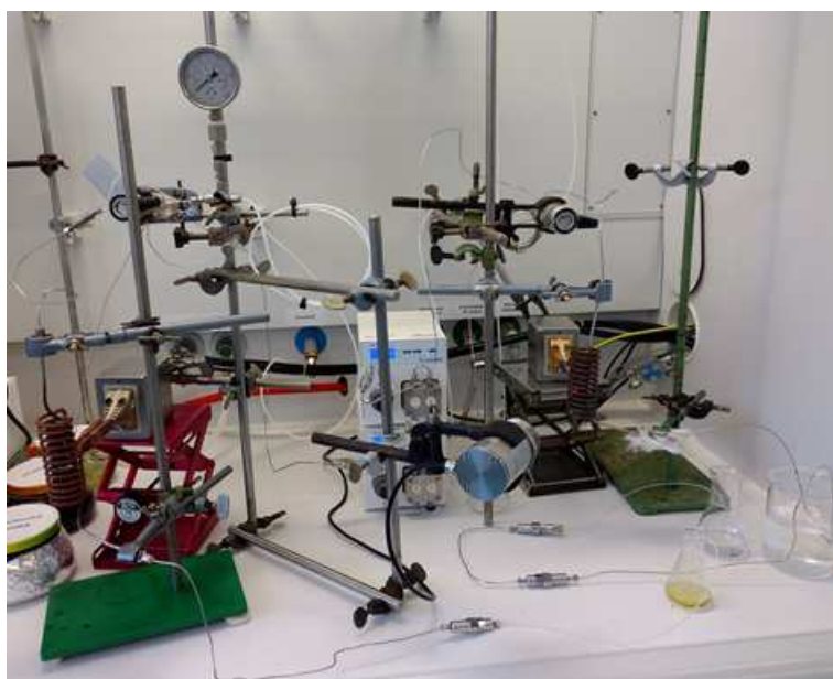
Abbildung 25: Zwei Durchflusssysteme mit jeweils einer HPLC-Pumpe, einem Wickelreaktor, einem 6-Wege-Ventil, Rückdruckventilen sowie die Ergänzung des einen Durchflusssystems mit einem tube-in-tube -Reaktor.
