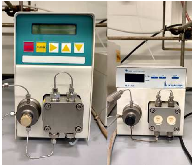
Abbildung 18: Links: HPLC-Pumpe des Typs K-501 von der Firma KNAUER; rechts: HPLC-Pumpe des Typs Azura P4.1S von der Firma KNAUER.
