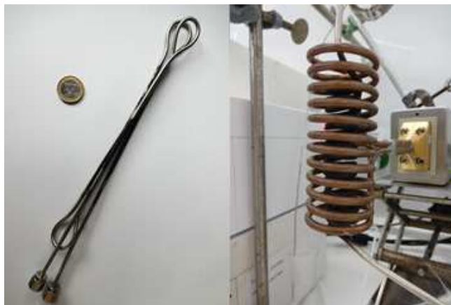
Abbildung 7: Verwendete Reaktoren in der Durchflusssynthese. Links: Schleifenreaktor; rechts: Wickelreaktor in der Induktorhalterung.
