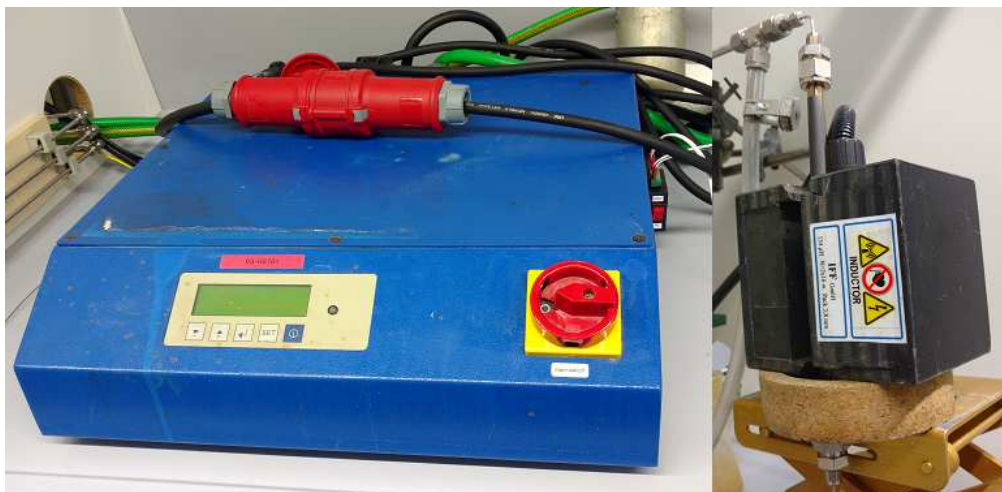
Abbildung 22: Links: Mittelfrequenzumrichter EW5W (15-25 kHz); rechts: Induktor mit einem Spaltmaß von 11 mm.
