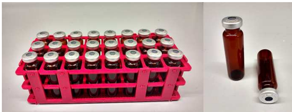
Abbildung 64: Probengefäße zur Probennahme unter inerten Bedingungen für die spätere Headspace -Analyse bei der BGR.
