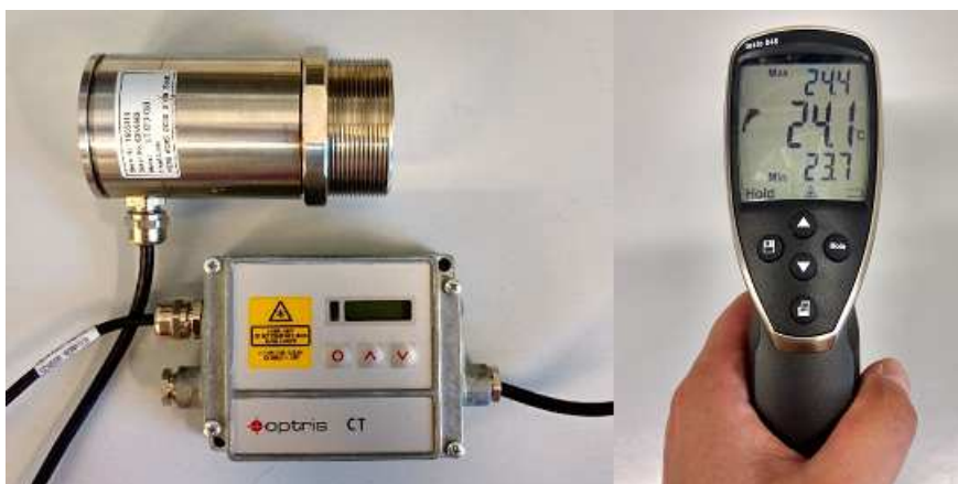
Abbildung 21: Links: Computergesteuertes IR-Pyrometer; rechts: Handbetriebenes IR-Pyrometer.
