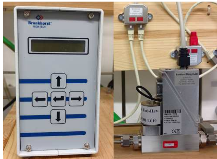
Abbildung 19: Links: Verwendeter Flow-bus; rechts: Angeschlossener Massendurchflussregler.
