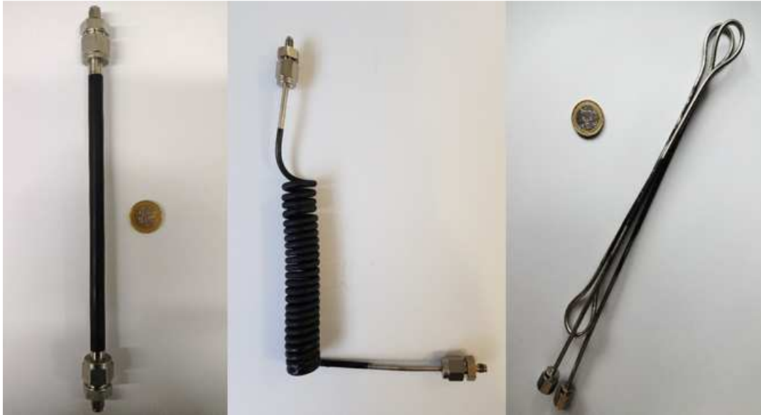
Abbildung 20: Edelstahlreaktoren unterschiedlicher Geometrien und Größen: Rechts: 3/8"-Stabreaktor; Mitte: 1/8"-Wickelreaktor; links: 1/8"-Schleifenreaktor.
