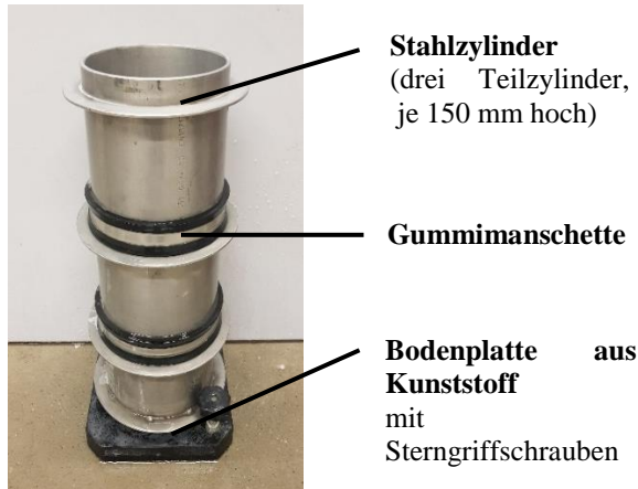
Bild 3: dreiteiliger Sedimentationstopf aus Stahl
