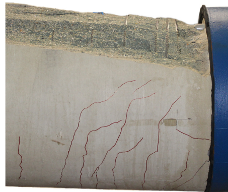
Bild 12: Biegemoment-Verschiebungs-Kurve (links) und typisches Versagensbild (rechts) eines Großversuchs
