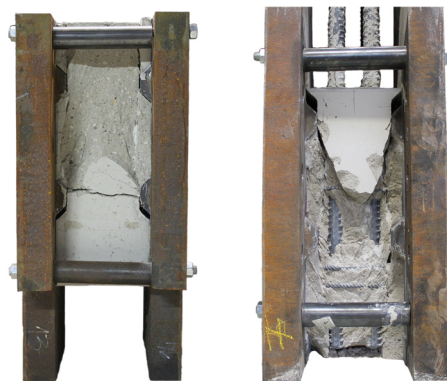
Bild 8: Verbundspannungs-Schlupf-Beziehung eines Druckversuchs (links) und typische Bruchbilder (rechts)
