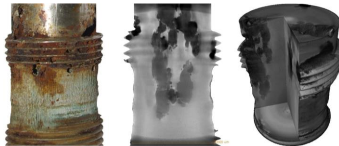
Bild 4: Korrodiertes stabförmiges Bauteil der Prototyp-Messeinheit aus GIGAWIND alpha ventus (links) und CT-Aufnahme des Bauteils (mitte, rechts) (Lohaus et al. 2017)
