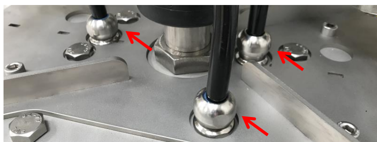
Bild 6: Seewasserbeständige Kabeldurchführungsbauteile von Messeinheit II (Rolfes et al. 2018)
