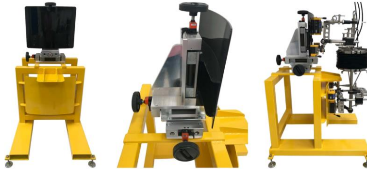
Bild 9: Prüfgestell (links), Linearmodulsystem (mitte) und Prüfgestell mit installierter Messeinheit II (rechts) (Rzeczkowski et al. 2019)
