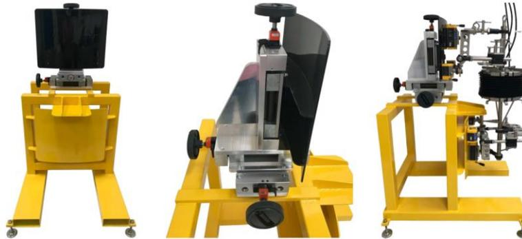
Bild 9: Prüfgestell (links), Linearmodulsystem (mitte) und Prüfgestell mit installierter Messeinheit II (rechts) (Rzeczkowski et al. 2019)
