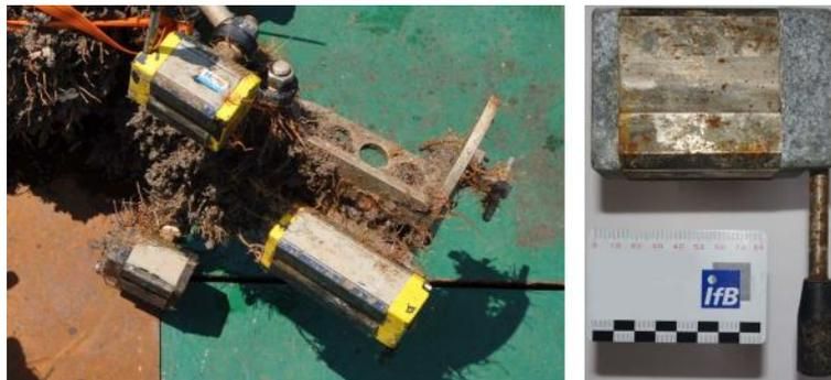
Bild 5: Geborgene Prototyp-Messeinheit (links) und Lasthebemagnet (rechts) aus GIGAWIND alpha ventus
