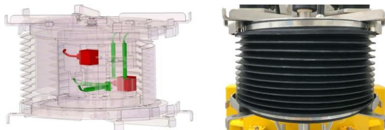
Bild 8: Anordnung der induktiven Wegaufnehmer (grün) und der triaxialen Beschleunigungssensoren (rot) in Messeinheit II (Rolfes et al. 2018)
