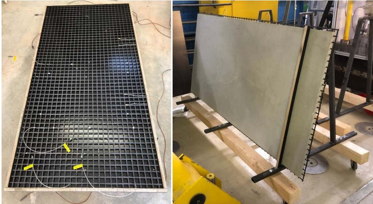
Bild 11: Textildbewehrung mit faseroptischen Sensoren (links) und Platte nach dem Ausschalen (rechts)
