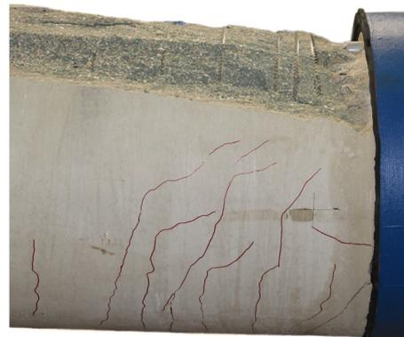
Bild 12: Biegemoment-Verschiebungs-Kurve (links) und typisches Versagensbild (rechts) eines Großversuchs
