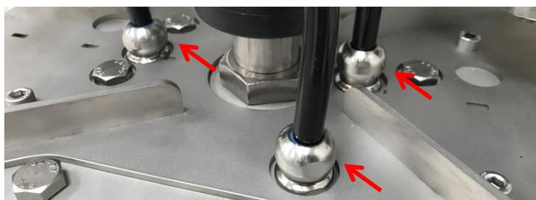
Bild 6: Seewasserbeständige Kabeldurchführungsbauteile von Messeinheit II (Rolfes et al. 2018)
