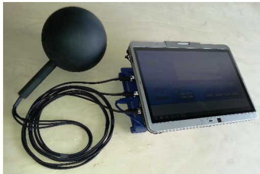
Bild 8: Messsystem für Störfeldmessungen mittels 3D-Searchcoils
