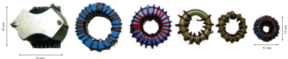
Bild 1: Übersicht verschiedener Kernmaterialien zur Verwendung als Speicherdrossel sowie als EMV - Filterelement.
