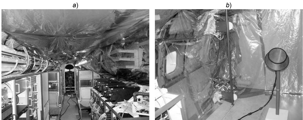
Bild 1: Absorberfolien a) an der Decke und b) vor dem Druckschott und an den Seitenwänden (inkl. hintere Flugzeugtür und Fenster) mit Sendeantenne im Vordergrund
