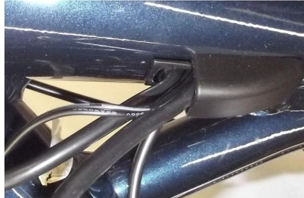
**Bild 4b:** Kabelführung am Lenker
