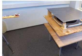
Abbildung 3: Anwendung des in Abbildung 2 skizzierten Messaufbaus für die Messung der abgestrahlten Feldstärke zwischen 9 kHz und 30 MHz mit der magnetischen Rahmenantenne
