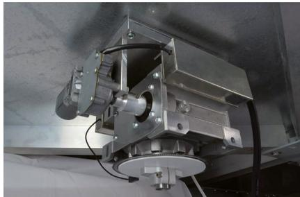
Abbildung 2: Elektromotor unterhalb des GTEM-Zellenbodens
