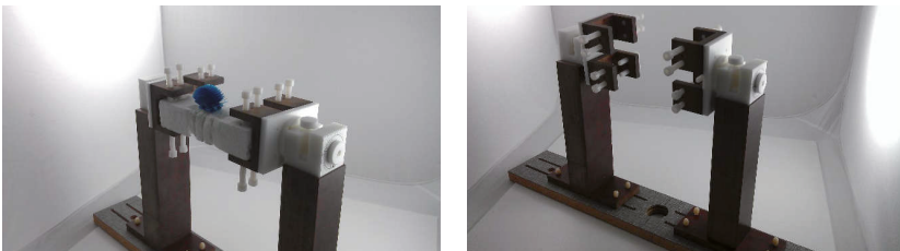
Abbildung 2: Halterung aus Holz und Kunststoff mit frei wählbaren Neigungswinkel
