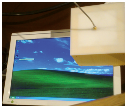
Abbildung 8: Prüfaufbau zur Erprobung der TEM Hornantenne
