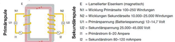
Bild 2: Prinzipskizze – Aufbau einer Zündspule [3]
