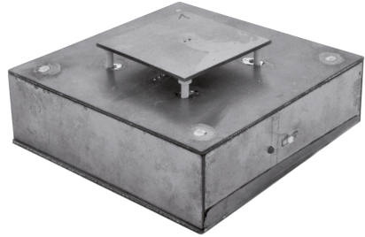
Abbildung 7: Testaufbau mit aufgestecktem Subboard ohne Massepfosten
