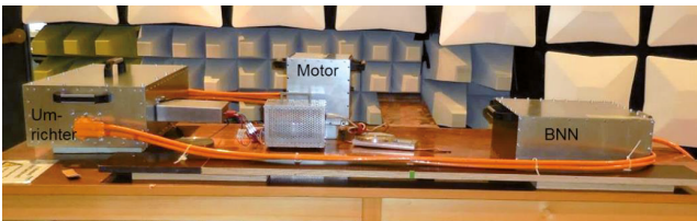
Abbildung 11 Messaufbau auf Komponentenmesstisch mit Umrichter als DUT und den Leitungen HV+ und HV- vor der Antenne
