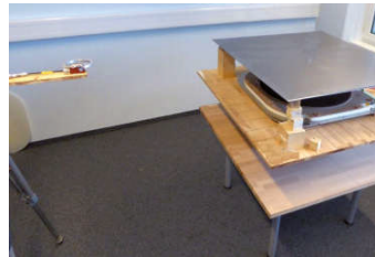
Abbildung 3: Anwendung des in Abbildung 2 skizzierten Messaufbaus für die Messung der abgestrahlten Feldstärke zwischen 9 kHz und 30 MHz mit der magnetischen Rahmenantenne
