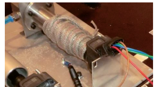
Bild 11: gestrahlte Störaussendung Kompakt-Zündspulen im offenen Messaufbau – Einfluss Masse im Zündspulenschacht
