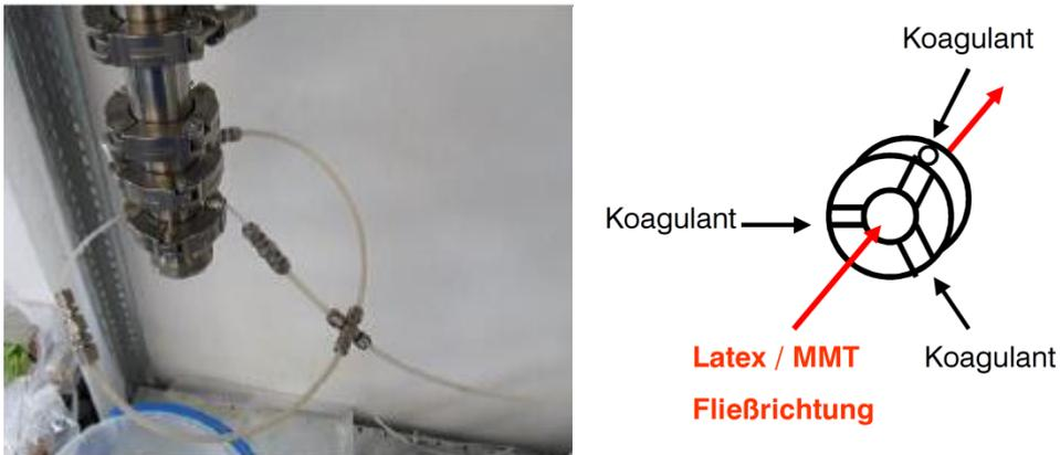
Abbildung 112: Links: Angeschlossenes Sternstück am Reaktor. Rechts: Schematische Zeichnung des sternförmigen Zulaufs des Koagulanten aus drei Richtungen.
