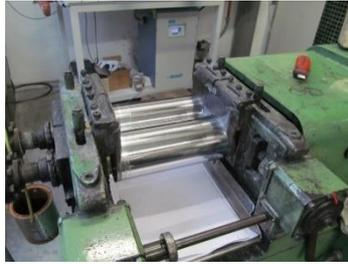
Abbildung 117: Troester Laborwalzwerk zur Einmischung von Füllstoffen oder Vulkanisationschemikalien in einen Kautschuk.
