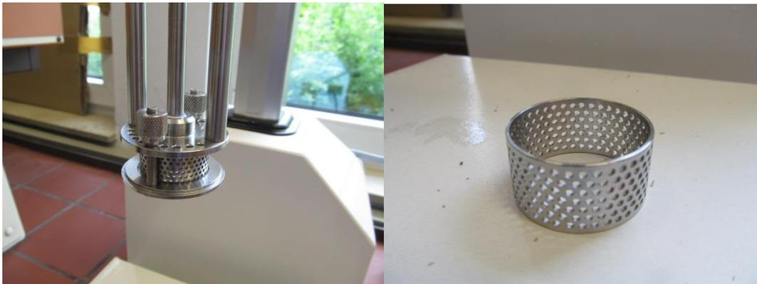
Abbildung 116: Links: Rührkopf des Ultramischer Silverson LM5. Rechts: Rührsieb des Ultramischer Silverson LM5.
