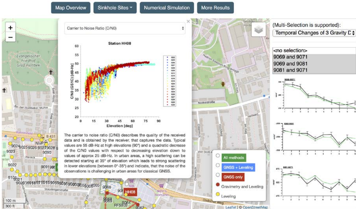
Abbildung 1.5.16: Beispiel einer interaktiven Karte, welche dynamische Ergebnisse (anklickbar, vergrößerbar) der GNSS, Schwere und der Nivellierungen in zwei aktiven Erdfallregionen in Hamburg-Flottbek darstellt. Zeitreihen der einzelnen Messpunkte können einzeln oder in Kombination abgerufen werden.
