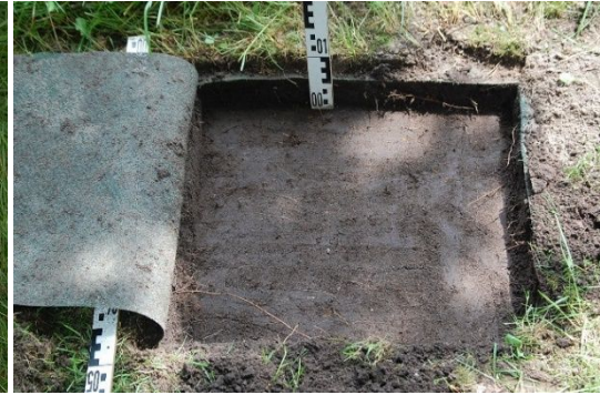
Abb. 53 d: Aufgrabungsbereich unter der Barriere Abtragstiefe 5 cm
