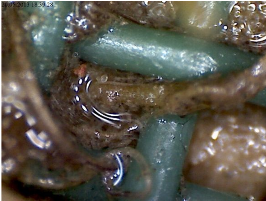
Abb. 47 a: Durchwurzelung der Barriere aus Monofilgewebe, Maschenweite 0,8 mm x 0,8 mm, 200-fach vergrößert
