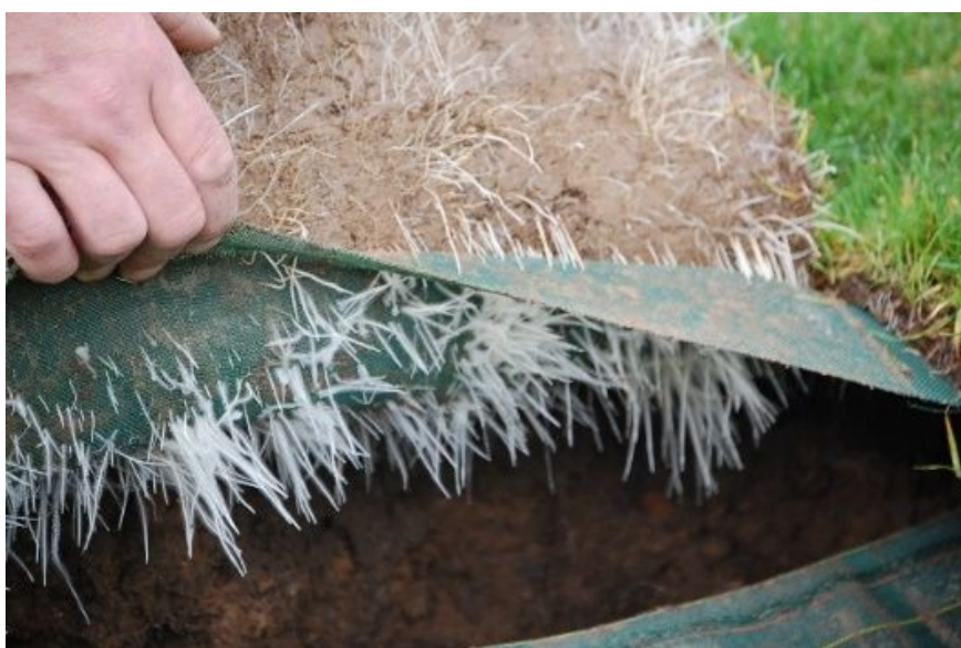
Abb. 66: In einen Hohlraum eingewachsene und weiterwachsende Rasenwurzeln bei hinreichender Wasserversorgung
