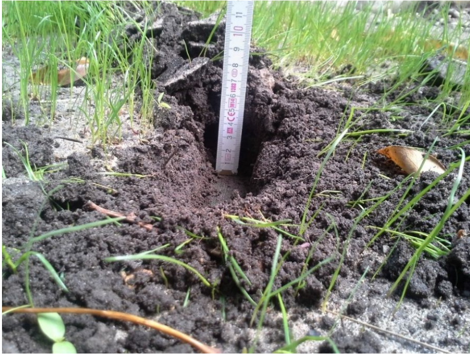
Abb. 62 b: Auftragsdicke des Bodens über der Barriere: 5 cm.
