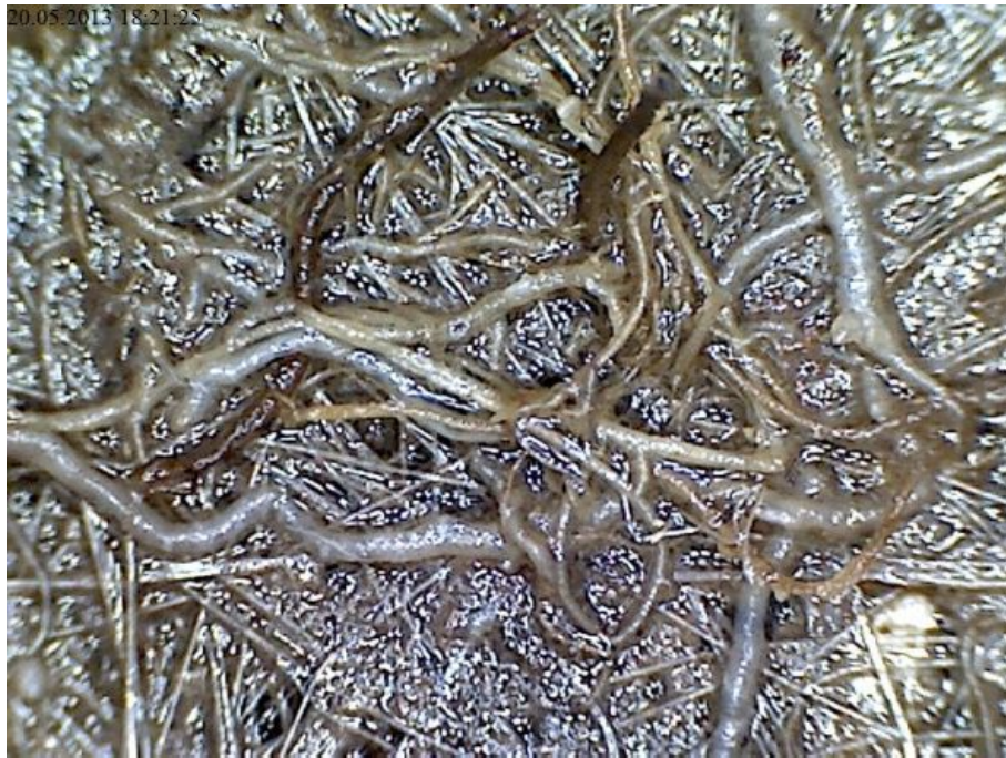
Abb. 48: Durchwurzeltes Spinnvlies, Öffnungsweite des Wirrgeleges 0,3 mm bis 0,5 mm 200-fach vergrößert
