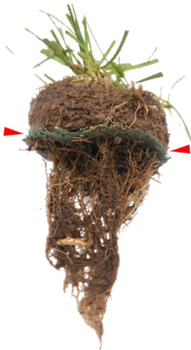
Abb. 45: freigespülte Rasenwurzeln gute Durchwurzelung der Barriere aus Monofilgewebe Maschenweite 0,8 mm x 0,8 mm
