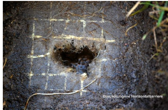
Abb. 31 d: Aufgekratztes, zerrissenes Spinnvlies
