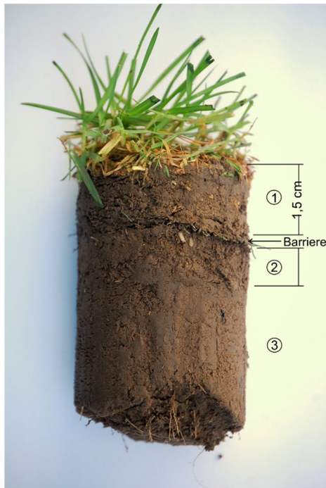
Abb. 33: Sandwichbauweise 1 Fertigrasen, Barriere, 2 alte Rasennarbe, 3 Boden
