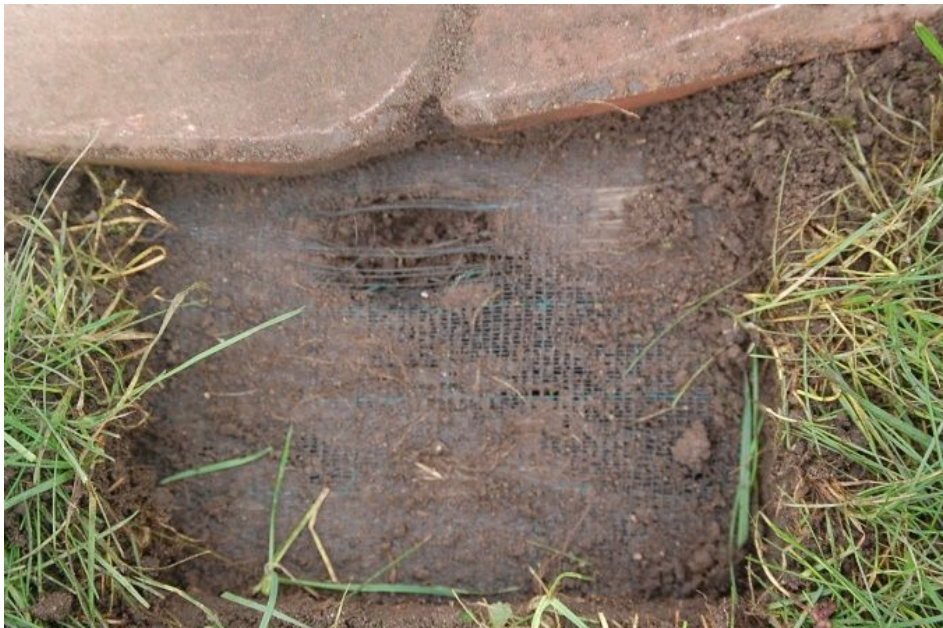
Abb. 30 c: Beschädigte, horizontale Barriere über Maulwurfsgang
