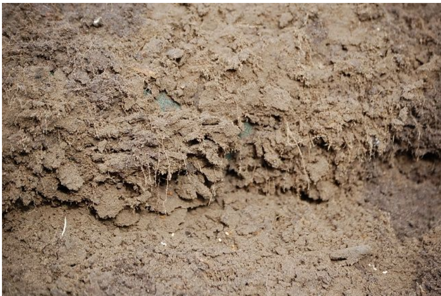
Abb. 44 b: Durchwurzelte Barriere der Maschenweite 0,8 mm x 0,8 mm mit anhaftendem Boden des Untergrundes
