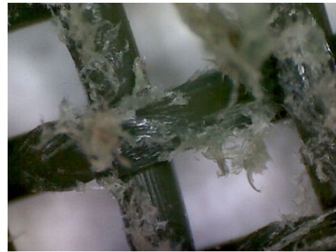
Abb. 77 d: Probe L5, Barriere mit Nagespuren 200-fach vergrößert
