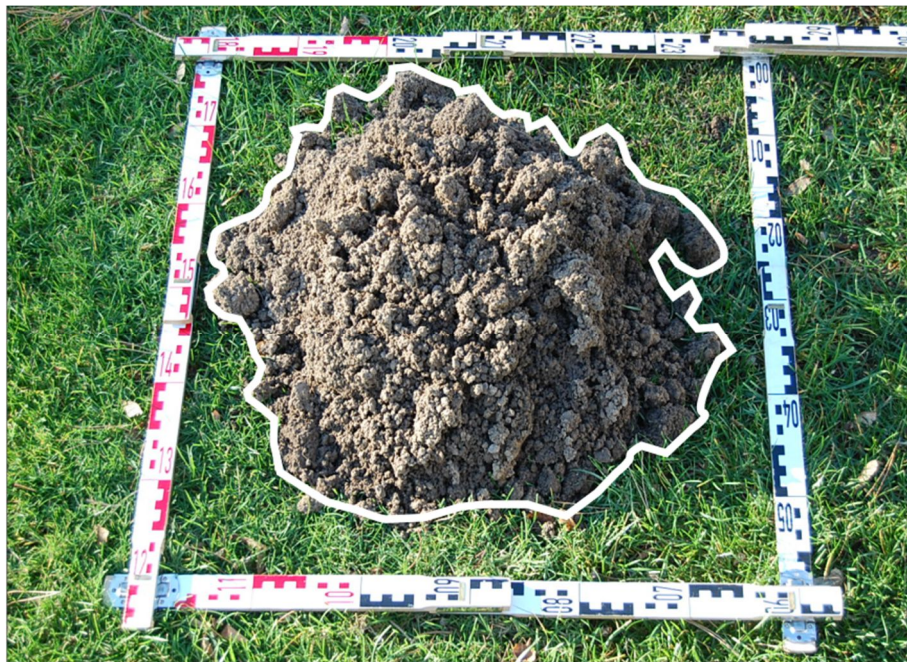
Abb. 13 a: Aufmaß eines Maulwurfhügels Durchmesser 40 cm, Höhe 15 cm
