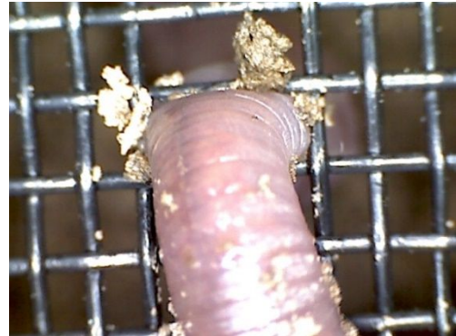
Abb. 81 b: Maschenweite 1,8 mm x 4,3 mm Wurmumfang: 14 mm Wurmdurchmesser: 4,8 mm
