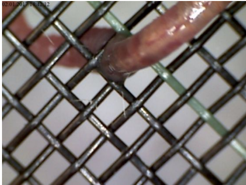
Abb. 81 a: Maschenweite 1,1 mm x 1,7 mm Wurmumfang: 10 mm Wurmdurchmesser: 3,26 mm
