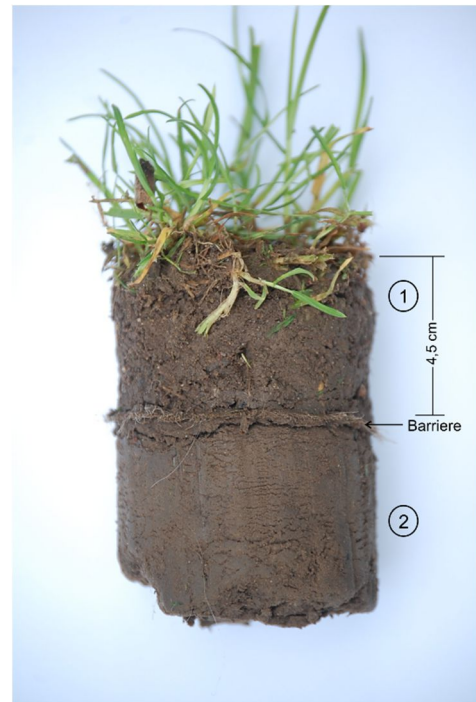
Abb. 34: Überdeckte Bauweise, 1 Überdeckung mit Ansaat Barriere, 2 Boden
