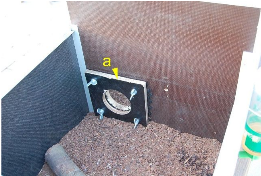
Abb. 72 b: Zugang zur Futterkammer (a) mit Klemmplatte aus Holz und eingeklemmter Barriere – bereits durchnagt.
