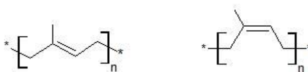
Abbildung 4: Poly(1,4- trans -isopren) (links) und Poly(1,4- cis -isopren) (rechts).
