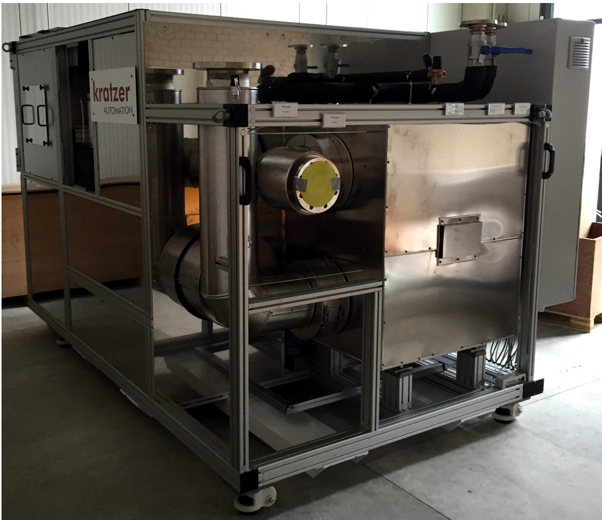
Abbildung E.1: ORC-Modul des Instituts für Kraftwerkstechnik und Wärmeübertragung der Universität Hannover außerhalb des Turboladerprüfstands (Seume et al. 2016)
