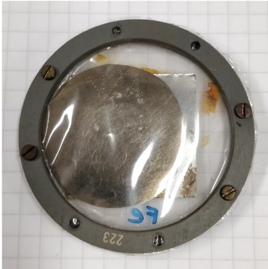
Abbildung 35: Probenhalter für Schichtmessung mit V2A-Stahl oben.
