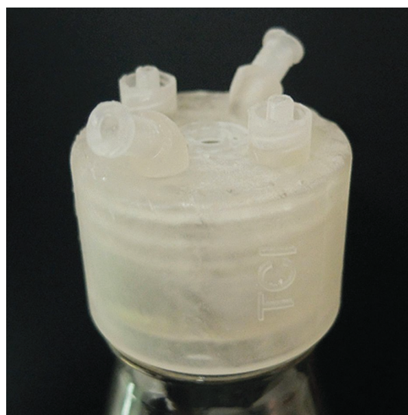
Abb. 8 Mit harzverarbeitenden SLA-3D-Druckern können funktionalisierte Kolbendeckel gefertigt werden. [Bild und Design Abb. 7 und 8: Lukas Raddatz]
