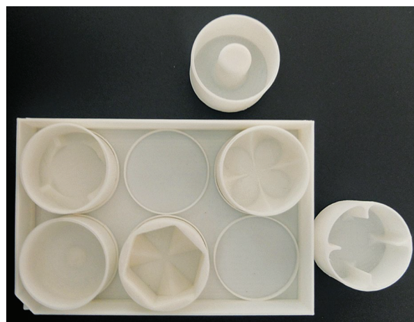
Abb. 7 Additiv gefertigte Kultivierungsgefäße wie diese modulare Mikrotiterplatte aus Polymilchsäure können für jedes Experiment individuell gefertigt und auf die Ansprüche der verwendeten Organismen angepasst werden werden.
