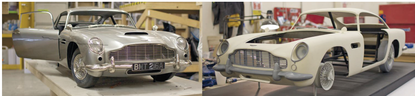
Abb. 5 Der im James-Bond-Film „Skyfall“ zu sehende Aston Martin DB3 wurde für die Dreharbeiten im Maßstab 1:3 aus Polymethylmethacrylat (PMM) nachgebaut, damit im Film kein echter zerstört werden musste. [Bild: voxeljet AG]
