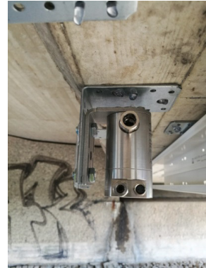
Abbildung 3: Darstellung Regelmessquerschnitt und Schlauchwaagengefäß vor Anschluss der Schläuche
