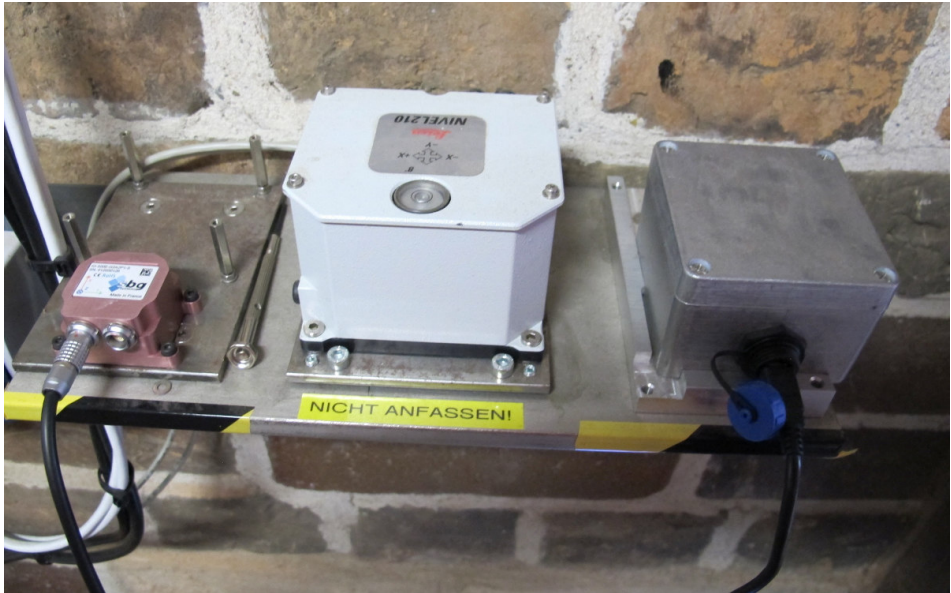
Abbildung 2: Sensoraufbau innerhalb der Marienkirche Neubrandenburg (v.l.n.r.: SBG IG-500E, Leica Nivel210 und Low-Cost-MEMS)
