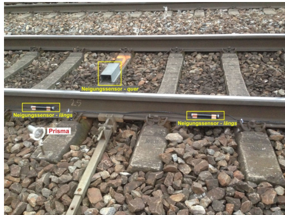
Abbildung 8: Quer- und Längsneigungssensoren Amberg TrackControl
