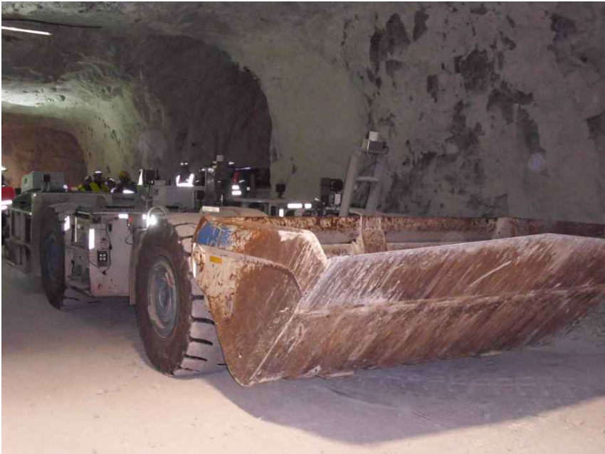
Abbildung 6: GHH-Lader SLP-8H mit Sensorik ausgerüstet für autonomes Fahren in einer 3D-Umgebung im Einsatz bei maxit, Krölpä.
