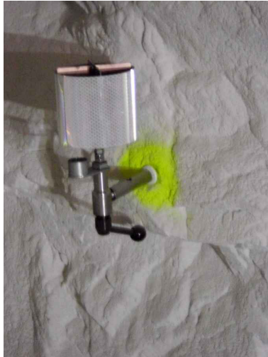
Abbildung 17: Universalreflektor für LiDAR und RADAR.
