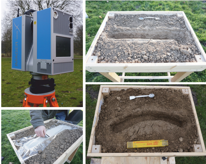
Abbildung 6: Versuchsaufbau: Oben links: Z+F Imager 5010X, unten links: Verfüllung der künstlichen Formen mit Quarzsand, oben rechts: künstlich angelegte Erosionsform mit angeschrägter Längsseite (Form 1), unten rechts: künstlich angelegte, gebogene Erosionsform (Form 2)
