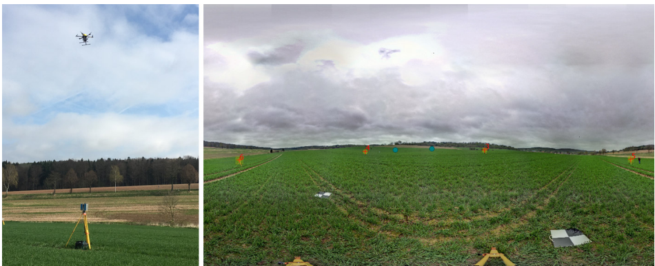
Abbildung 3: TLS Einsatz in Lamspringe - Links: Zoller+Fröhlich Imager 5010X und UAV Trimble ZX5 bei der Datenerfassung. Rechts: Statisch erfasste und colorierte 3D-Punktwolke
