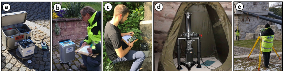
Abbildung 3: Überblick über die für diese Studie genutzten Instrumente (Fotos: LIAG und LUH) – Relativgravimeter: (a) LaCoste & Romberg Typ G (Messunsicherheit einer Einzelmessung \leq 10 \mu\text{Gal} ); (b) Scintrex CG5 ( \leq 5 \mu\text{Gal} ); (c) ZLS-Burris ( \leq 5 \mu\text{Gal} ). Absolutgravimeter: (d) FG5X-220 (Unsicherheit einer Stationsbestimmung \leq 2 \mu\text{Gal} ) Vermessungsgerät: (e) Leica DNA 03 Digitalnivellier mit Invar Code Latten ( \sim 1 \text{ mm pro km Doppelnivellement} ).
