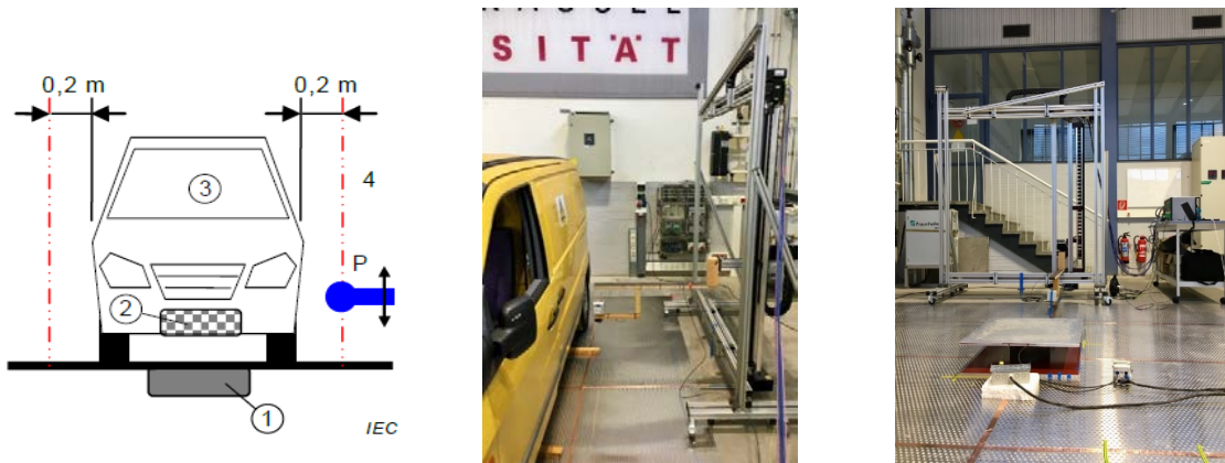
Bild 5: Links, Messanordnung gemäß der IEC 61980-1 [2]; Feldscanner mit Feldsonde und Boden mit Stahlplatten ausgelegt: Mitte, mit Testfahrzeug und rechts, ohne Testfahrzeug
