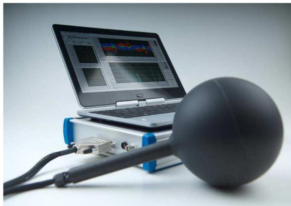
**Bild 4:** Messsystem für Störfeldmessungen mittels 3D-Searchcoils
