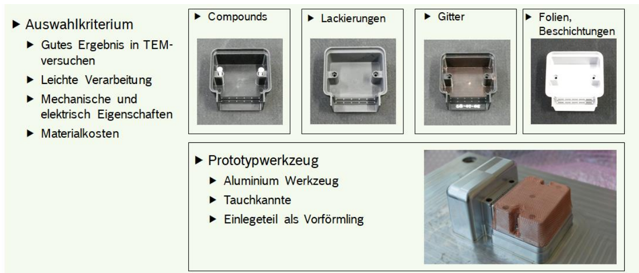
Bild 7: Darstellung der hergestellten Gehäuse mit Übersicht der getesteten Materialien (Auswahl, oben) und Detail des Prototypwerkzeugs mit Tauchkannte und eingelegtem Vorförmling.
