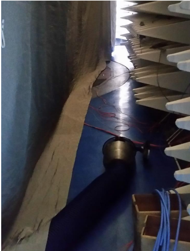
Abbildung 4: Ansicht außerhalb der VIRC, links Wand der VIRC und rechts Absorber der Halle
