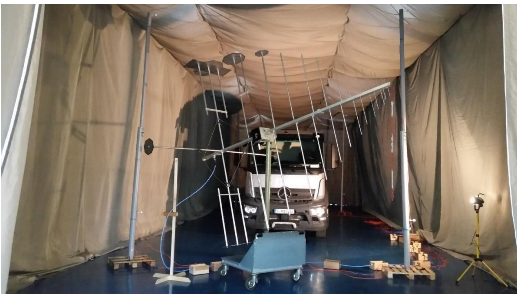
Abbildung 8: LKW in Prüffeld, definiertes Prüfvolumen innerhalb der Säulen wird mit einer LogPer-Antenne bestrahlt.
