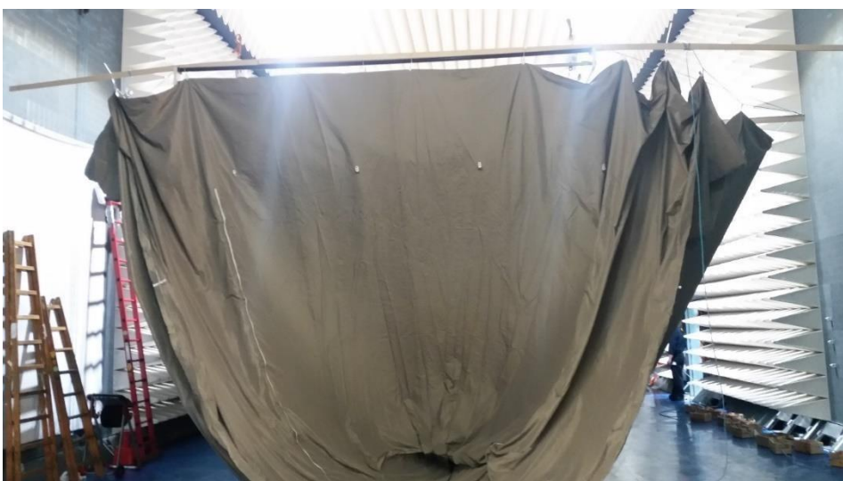
Abbildung 3: Entfaltung des Zelt-Prototypen an Stripline beim Hochfahren
