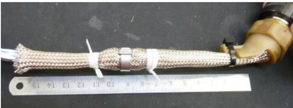
**Bild 18:** Verbindung Schirmung zum Stecker
