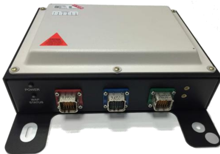
Bild 1: Cabin Wireless Access Point: Das Gerät lässt sich wegen der spezifischen Anschlüsse nicht außerhalb einer Flugzeugzelle betreiben
