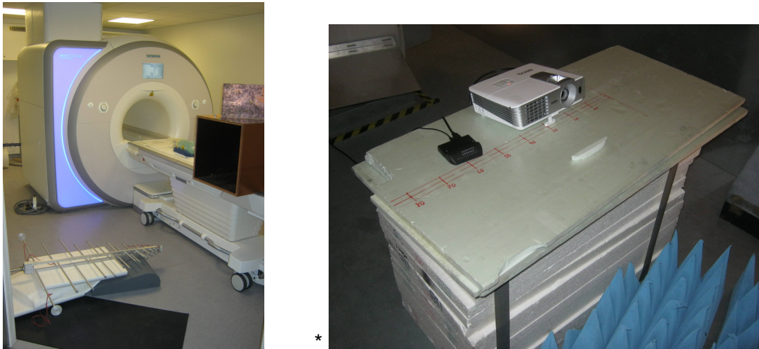
Bild 3: „Rührersetup“ in der Schirmkabine des MRT (links) und untersuchter Prüfling in der MVK (rechts)
