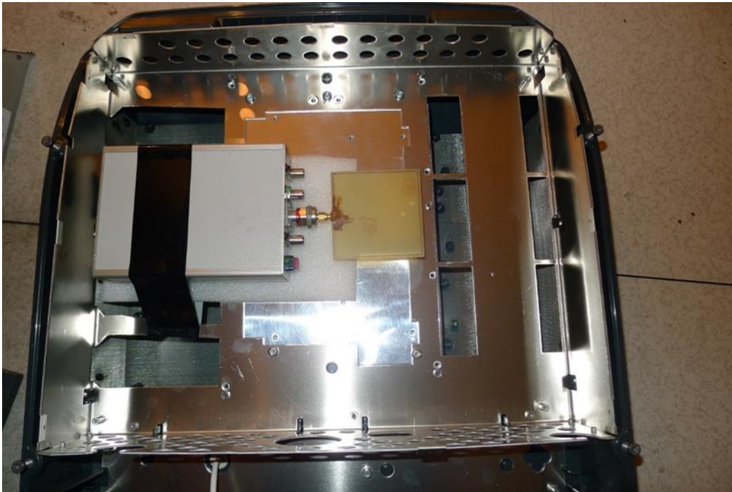
Bild 5: Gerätegehäuse mit Kammgenerator zur Bestimmung der Schirmdämpfung
