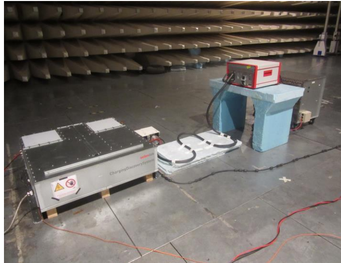
Bild 6: Messaufbau zur Untersuchung des EMV Verhaltens des Gesamtsystems
