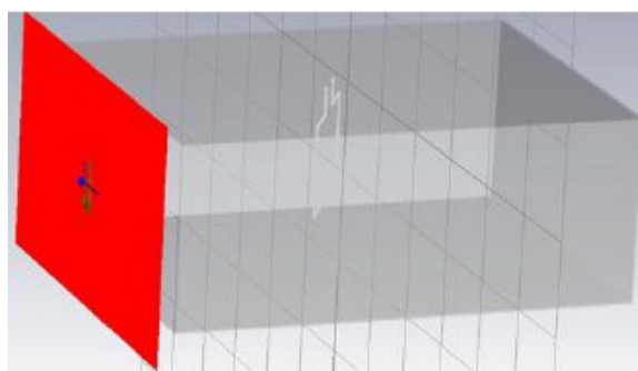
Bild 3: Im Simulationsmodell wird der grau dargestellte Resonator durch eine ebene, gepulste Welle angeregt, welche durch die rote Ebene symbolisiert ist [20]. Erkennbar ist im Inneren des Resonators auch eine rechteckförmige Drahtantenne, die nichtlineare Bauelemente enthalten kann.
