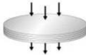
Abbildung 2-3 Strömungsrichtung eines klassischen Membranadsorbers (axiale Strömungsrichtung). [20]
