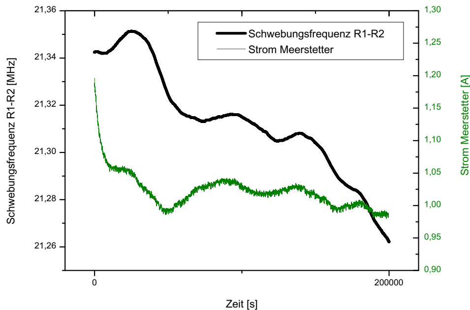
Abbildung 4.15: Eine Langzeitmessung, an der erkennbar ist, dass zwischen der Temperaturregelung, genauer dem implizierten Regelstrom der Heizelemente, und der Laserfrequenz eine Korrelation mit einer relativ großen Zeitkonstanten von einigen 100 Sekunden besteht.
