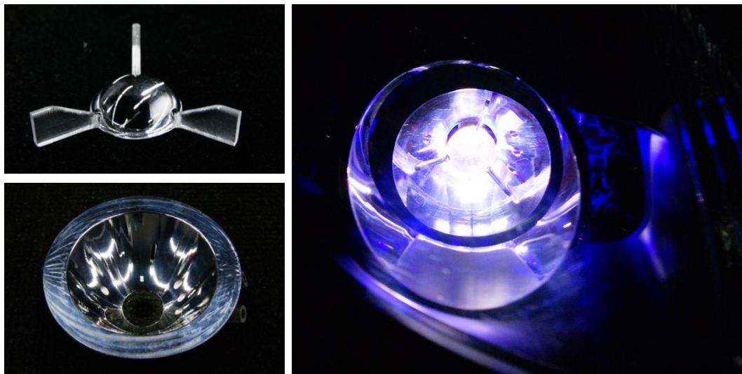
Bild 10: Am IPeG HSC-gefräste Linse und Reflektor sowie aufgebautes Lasermodul mit blauem „Laserglanz“ (im Fahrzeugscheinwerfer integriert)
