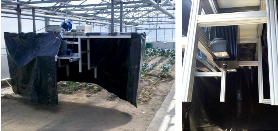
Abb. 4.11: Messplatz zur Messung des Wassergehalts von Brokkoli-Pflanzen im Gewächshaus am BGT Hannover (links), EVK Helios Core Sensor- und Beleuchtungsanordnung in der Zentralfähigung mit Lichtvorhang zu Reduzierung von Fremdlichteinflüssen
