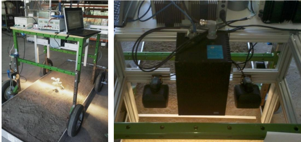
Abb. 4.10: Spectral Imaging Messsystem (Fahrgestell-Messplatz) bestehend aus einem motorisch angetriebenen Fahrgestell, Beleuchtungseinheit und Spektralsensor
