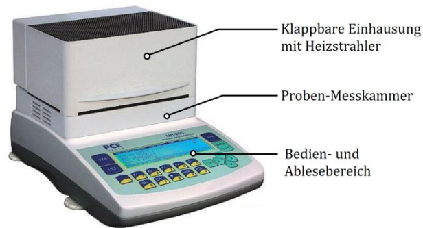
Abb. 4.1: Analyse-Waage PCE-MB100 zur Messung der Frisch- und Trockenmasse der Pflanzenblätter als Grundlage der Referenz-Wassergehaltsanalyse (PCE 2017)
