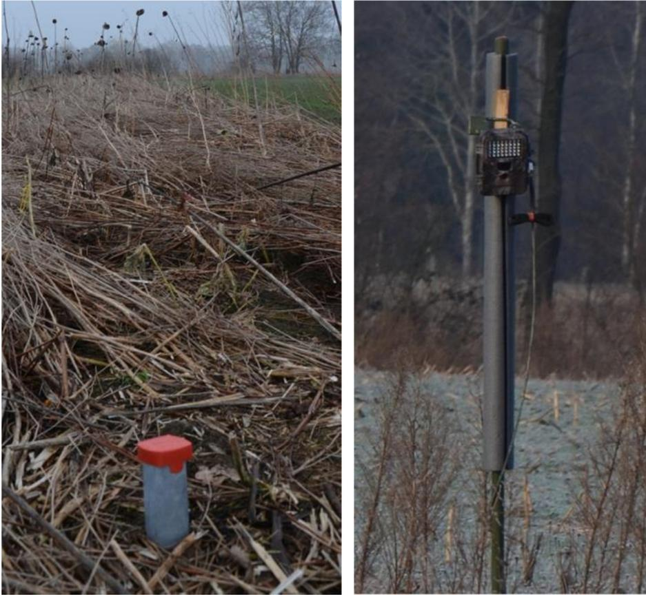
**Abb. 2:** Bodenhülse (links, Foto: Wix, 17.02.2103) und Befestigung und Sicherung der Kamera an Metallstange mit Styropor-Keil (gelb) (rechts, Foto: Wix, 12.01.2103).
