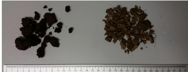
Abbildung 14: Reisstrohgärrest im unbehandelten feuchten Zustand (links) und getrockneten Zustand (rechts).
