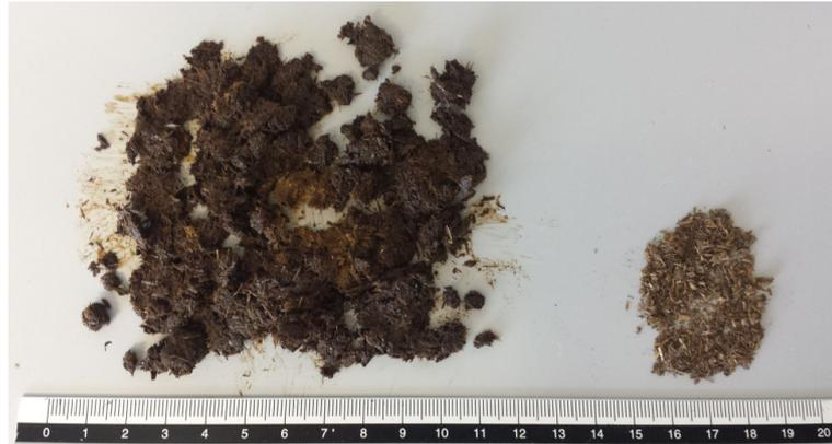
Abbildung 13: Weizenstrohgärrest im unbehandelten feuchten Zustand (links) und getrockneten Zustand (rechts).
