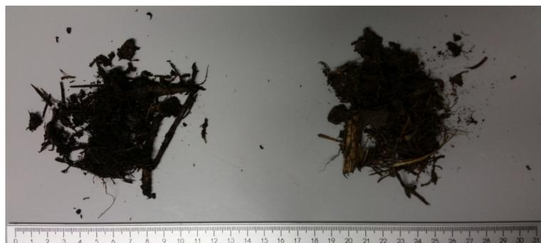
Abbildung 15: Grünschnittgärrest im unbehandelten feuchten Zustand (links) und getrockneten Zustand (rechts).
